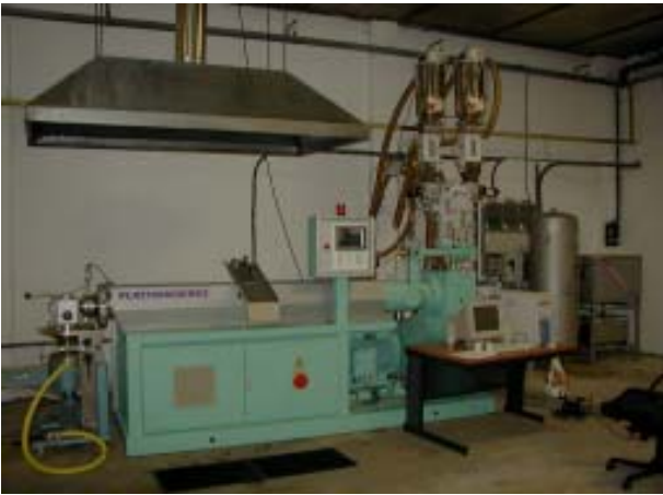
Regranulierung von Kleiderbügeln in den Niederlanden auf einer PME-Granulieranlage
