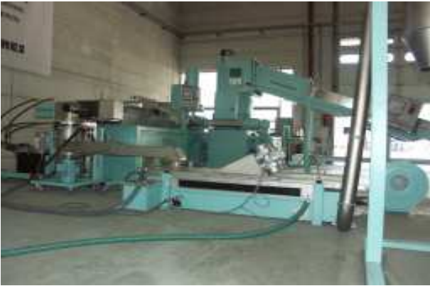
Kombi-Anlage ZTE für die Verarbeitung von PP-Materialien zu neuen Rohstoffen
